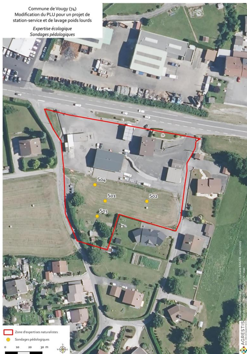
Figure 38: Sondages pédologiques et niveau d'hydromorphie
